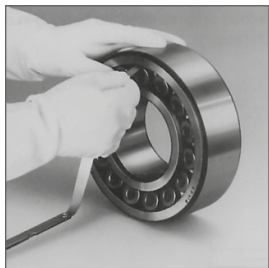
Рис. 1. Проверка зазора подшипника на верстаке.
